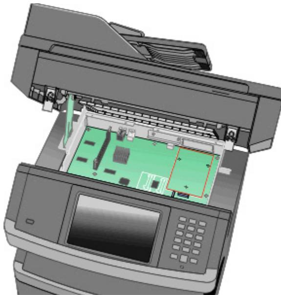
**注意：**如果当前已安装了可选的打印机硬盘，那么必须先移除打印机硬盘。要移除硬盘：
