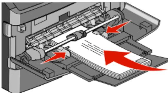
**警告—可能的损坏：**不要使用已粘贴邮票，有扣子、揷钮、窗口、涂层或自粘口的信封。这些信封会严重损坏打印机。
