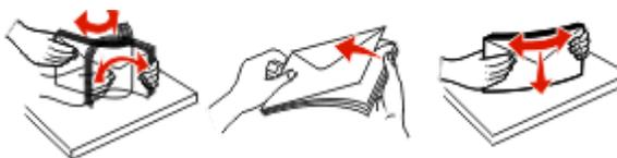
**注意：**扇形展开信封能防止信封边缘粘连在一起。这样也有助于正确送入信封并避免卡纸。不要折叠或弄皱信封。
