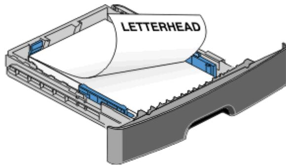
**5** 压住并滑动导片，使它们轻轻地接触到纸堆的边缘。
