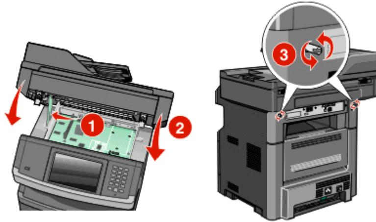
**警告—可能的损坏：** 确认系统板已被锁定，以防止打印机被移动时可能造成损坏。
