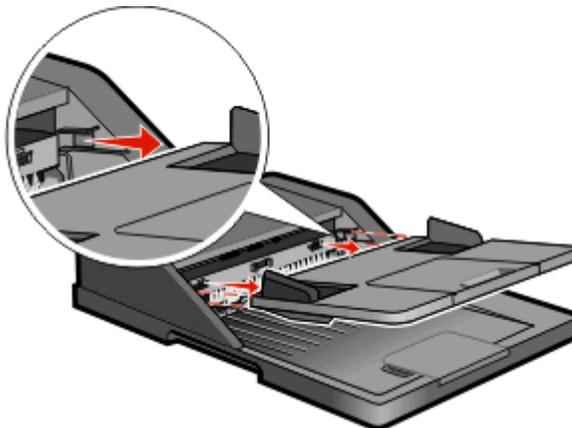
2 通过拉纸张的底部来拉出被卡的纸张。
