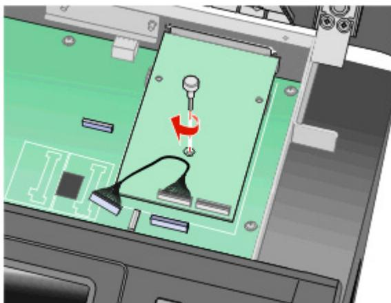
9 安装提供的两个螺钉来将 ISP 固定板固定在系统板框架上。
