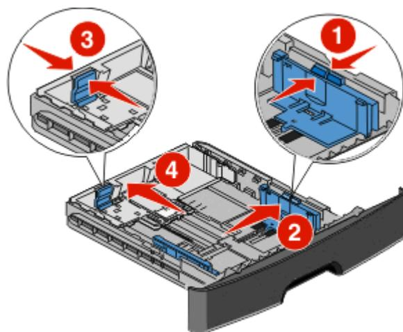
对于长纸张，如 A4 或 legal，请压住长度导片，并将它向后滑动到能容纳加载的纸张长度的位置上。
