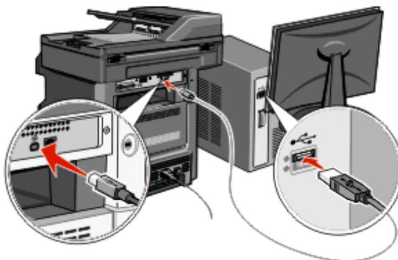
**注意：**打印机被配置后，软件将指导您断开临时的 USB 电缆连接，这样您可以实现无线打印。
